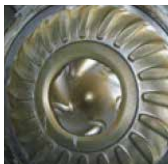
50%-ный износ рабочего колеса K-HEE™ 10G после 1300 часов
