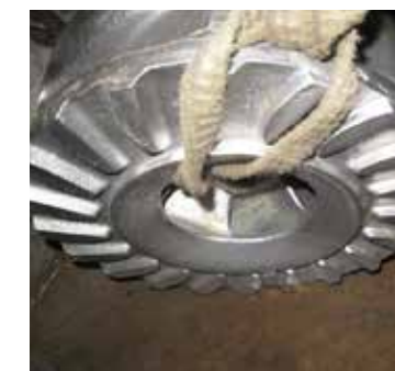
Всасывающая сторона рабочего колеса KETO через 580 часов эксплуатации выглядит новой, как и само рабочее колесо по наружному диаметру
