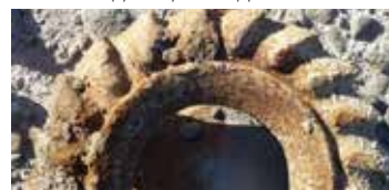
Лопasti традиционного рабочего колеса через 8 дней эксплуатации разрушены, рабочее колесо подверглось серьезной эрозии по наружному диаметру
